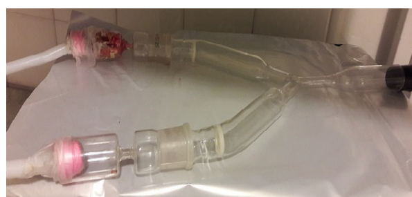
شکل ۱- بویایی‌سنج Y شکل مورد استفاده در آزمایش‌ها Fig. 1. Y-tube olfactometer used in the experiments
