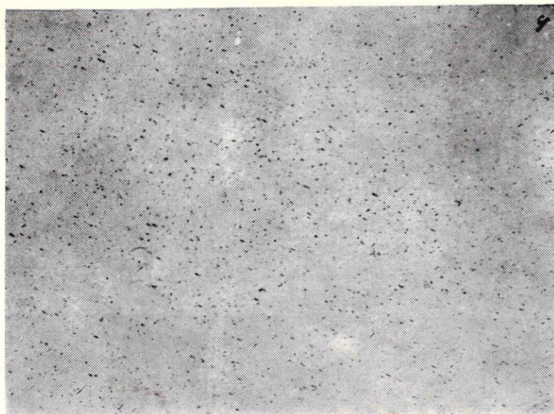
شکل شماره ۶: پوشش باچشمه D 4 در حالتیکه نازلها از محور عمودی خود ۳۰ درجه روبه جلو و کارت‌ها در ارتفاع ۱/۴۰ متری قرار گرفته‌اند
