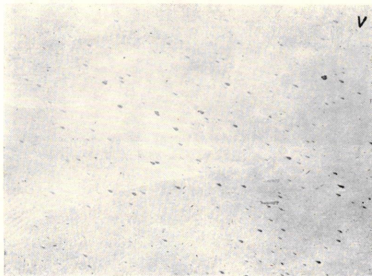
شکل شماره ۷: پوشش باچشمه D 6 در حالتیکه نازلها روبه عقب و کارت‌ها روی زمین قرار گرفته‌اند
